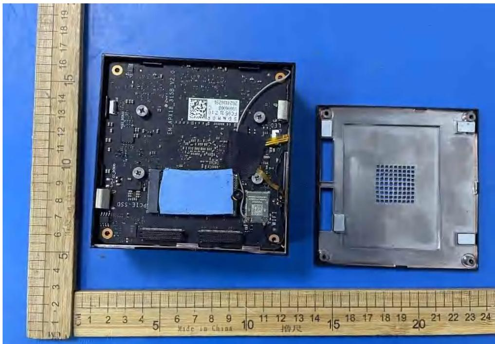
图八 内部结构
